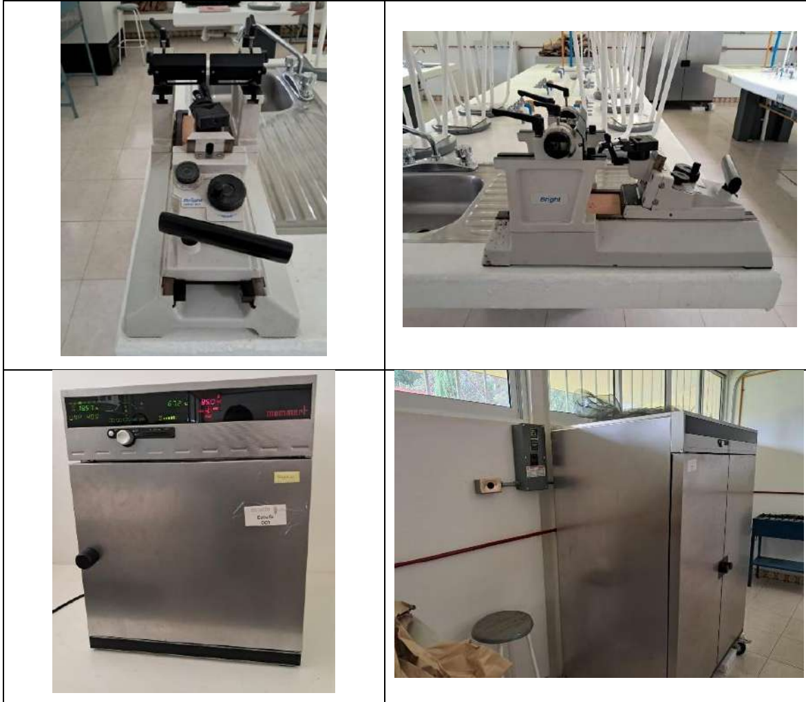
Figura 2. Xilotomo Bright (dos equipos) con cuchilla doble integrada, utilizados para realizar cortes anatómicos de muestras leñosas en estudios que evalúan las características microscópicas de madera (imágenes superiores; y dos estufas de secado (imágenes inferiores).
